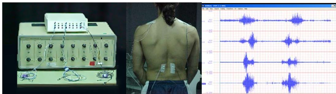
Figura 4. Sistema de EMG utilizado durante la realización de los ensayos de manipulación de carga y detalle de la ubicación de los electrodos (arriba). Señal de EMG registrada en un gesto de "lifting" y de "lowering" que incluía giro (abajo).
