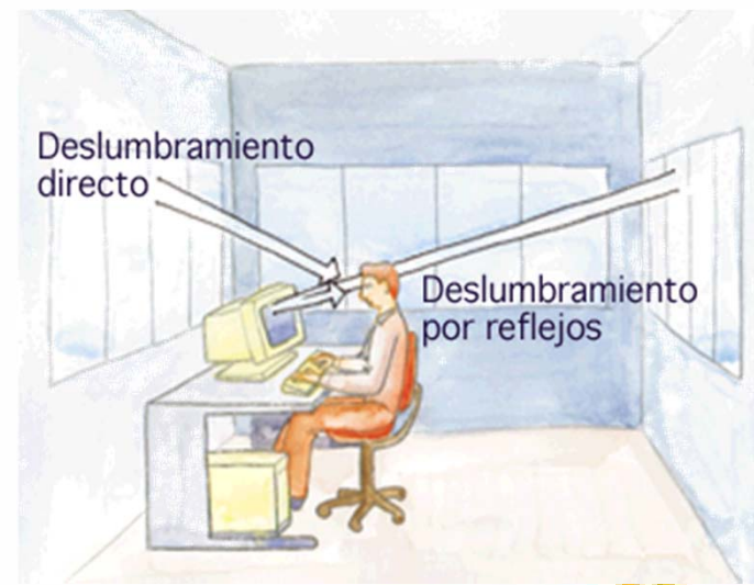
Instalación NO correcta
